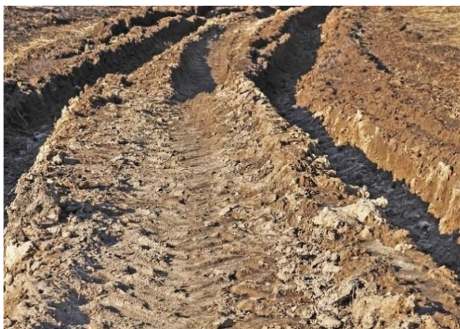
Рисунок 5.9 – Глубокая колея в песчано-глинистом грунте
