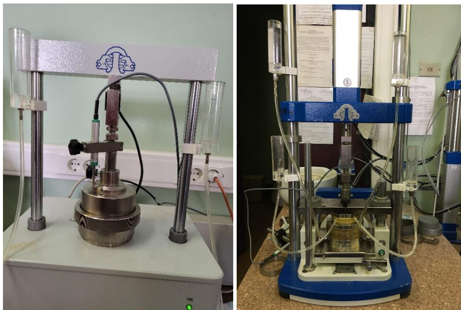
Рисунок 2.1 – Прибор компрессионного сжатия (а) и сборка комплекса АСИС для испытаний на многоплоскостной срез (б) (ООО НПП «Геотек»).
