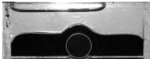
Рис. 1.17. Односвязный объем магнитной жидкости при H_\infty = 250 Э, линия - теоретический расчет.
