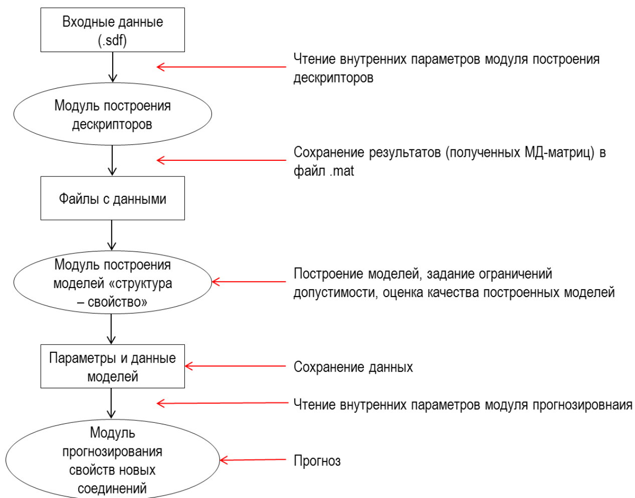
Рисунок 10. Схема работы программного комплекса прогнозирования свойств химических соединений
