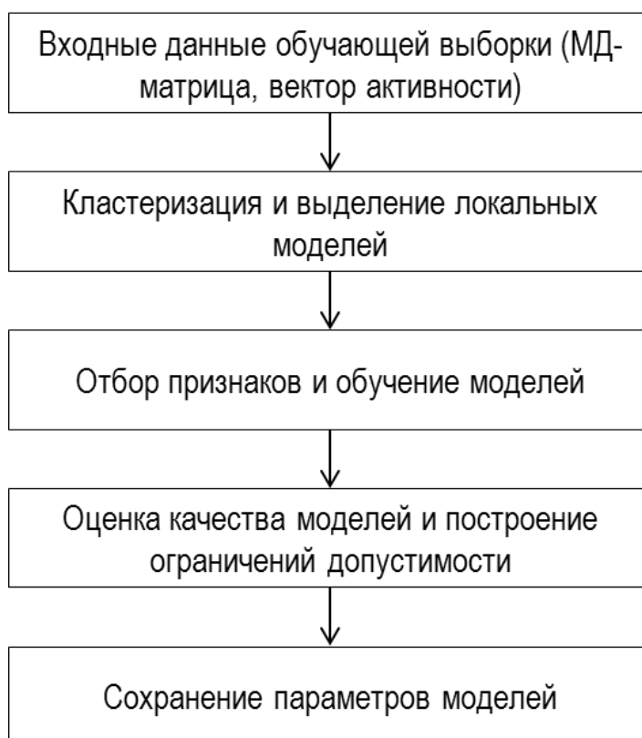
Рисунок 11. Схема работы модуля построения моделей «структура – свойство»
