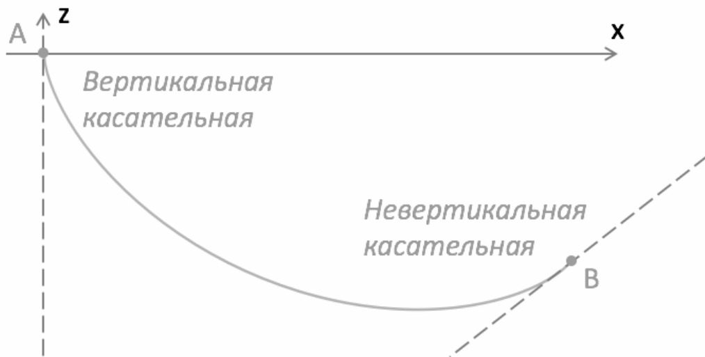
Рисунок 3.1 — Вид оптимальной траектории при действии постоянной разгоняющей силы на основе доказанных свойств.
