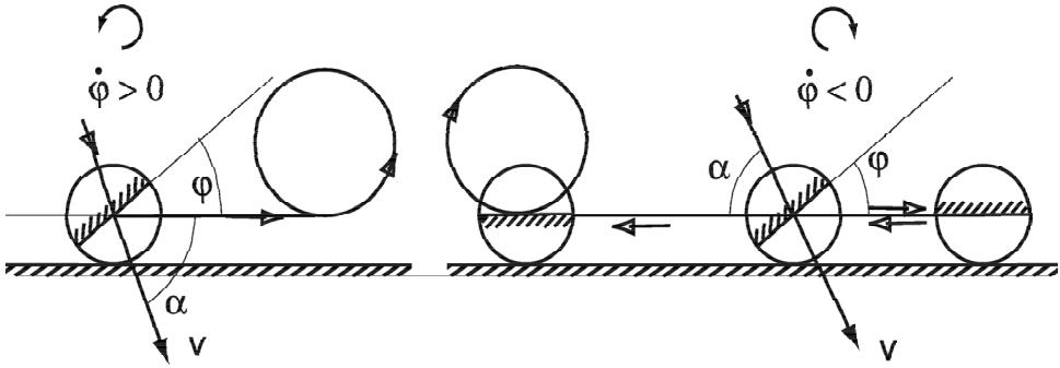
Рис. 11: Примеры ударов одностороннего конька  $\alpha = 2k\varphi$
