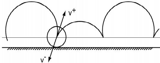
Рис. 4: Удар двустороннего конька о полуплоскость
