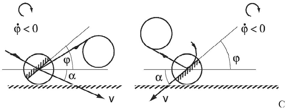
Рис. 7: Примеры ударов одностороннего конька  $\varphi \geq \alpha$
