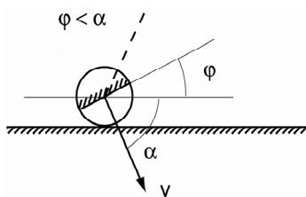
Рис. 8: Момент удара одностороннего конька  $\varphi < \alpha$
