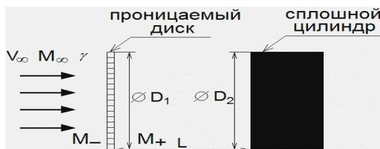
Рис. 3. Схема компоновки с проницаемым экраном,  $\lambda = L / D_2$
